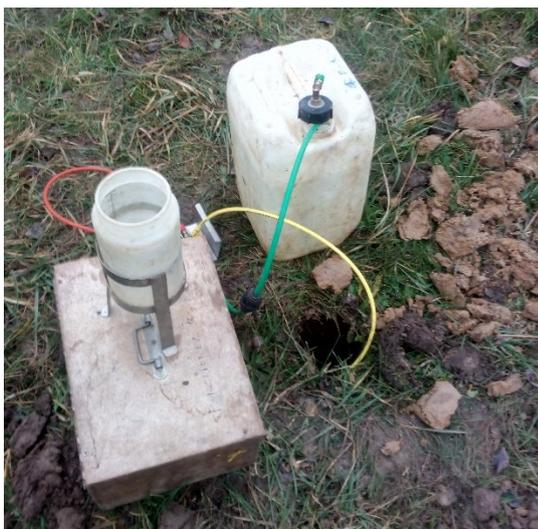
Figure 3.1 : Exemple d'essai Porchet
